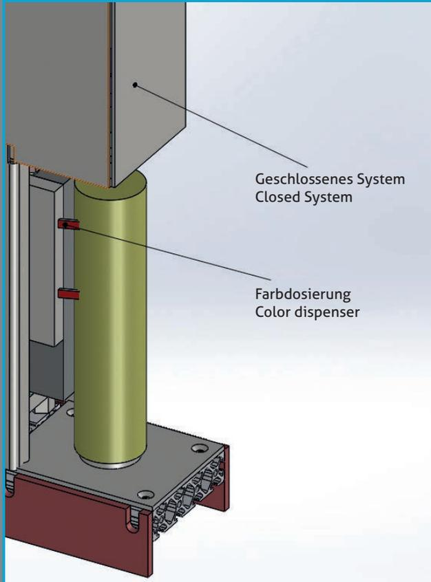
**PURity**, neues Kleberauftragungssystem mit folgenden Vorteilen:
