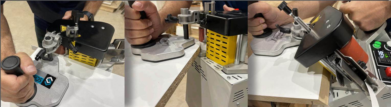
Perfektes Finish für gerade, runde und schräge Werkstücke (0° - 50°)
