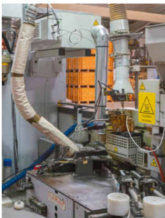
Das Aggregat sitzt über der Maschine und bringt die Luft nach unten zur Düse
