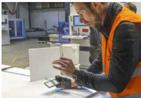
Detailprüfung: Matthias Hacker untersucht die Fuge zwischen Kantenband und Fläche mit einer elektronischen Lupe
