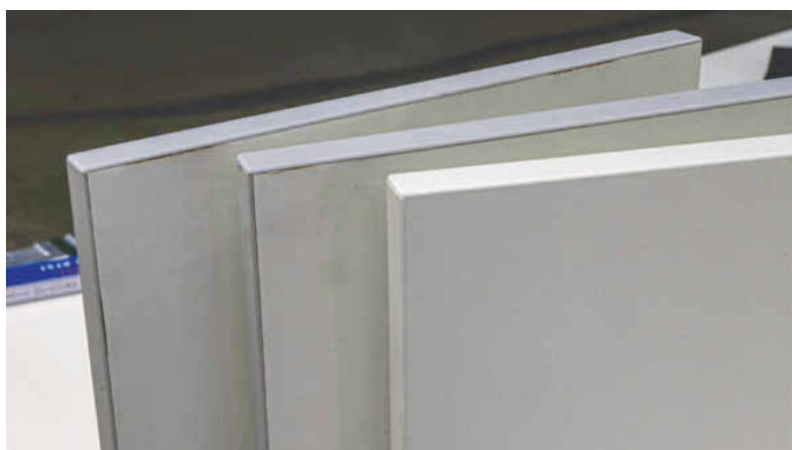
Proben nach dem Test: Vorne nur leicht lädiert (Hot Air), sehr ähnlich dahinter (viel PUR), ganz hinten deutlich gequollen (wenig PUR)
