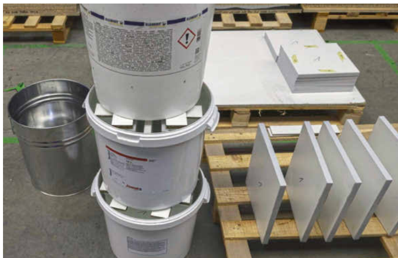
Vollständig untergetauchte Holzmuster, daneben aufrecht stehende Prüfteile
