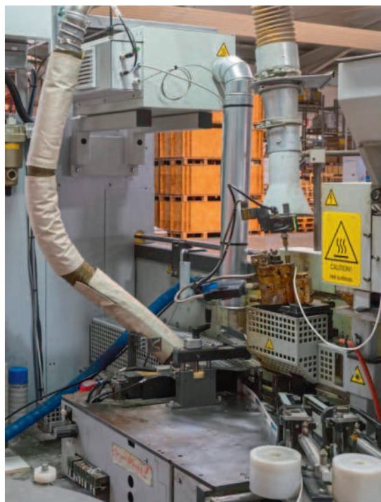
Il gruppo è montato sopra la macchina e convoglia l'aria verso il basso fino all'ugello
