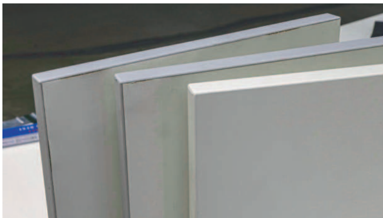
Campioni dopo la prova: davanti solo leggermente danneggiato (Hot Air), dietro molto simile (molto PUR), in fondo chiaramente rigonfio (poco PUR)
