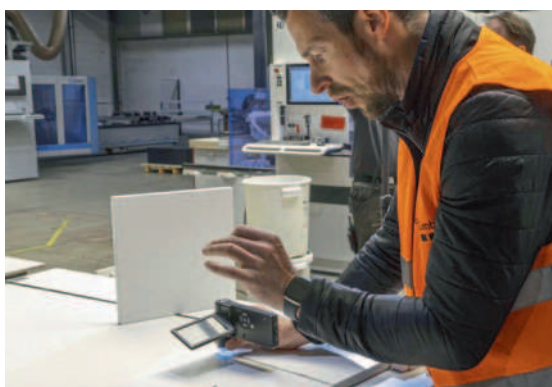
Controllo di dettaglio: Matthias Hacker esamina la fuga tra bordo e superficie con una lente elettronica
