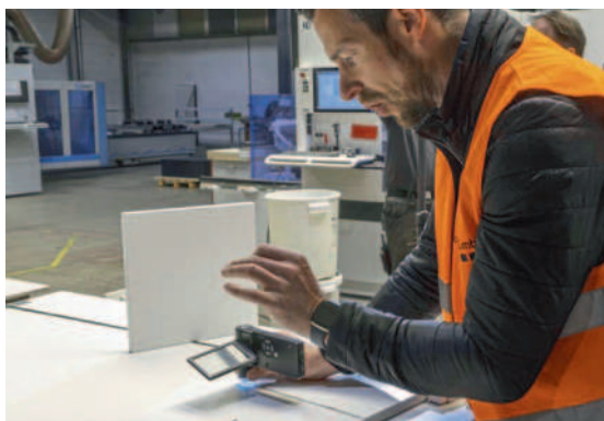
Kontrola szczegółowa: Matthias Hacker bada spoinę między obrzeżem a powierzchnią za pomocą elektronicznej lupy
