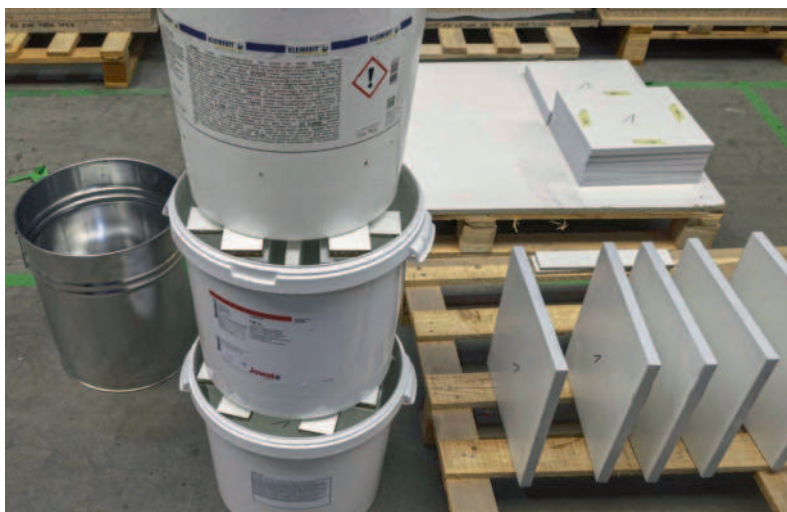
Całkowicie zanurzone próbki drewniane, a obok pionowo ustawione próbki
