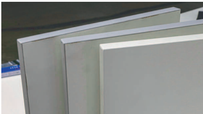
Próbki po teście: z przodu tylko lekko uszkodzona (Hot Air), za nią bardzo podobna (dużo PUR), z tyłu wyraźnie spęczniała (mało PUR)
